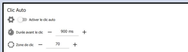
Déclenche le clic automatique par temporisation. Régler le temps avant l'action. La zone de clic détermine la zone à l'intérieur de laquelle un second clic ne se déclenche pendant cette temporisation. Sortir et entrer de la zone pour le réactiver.
